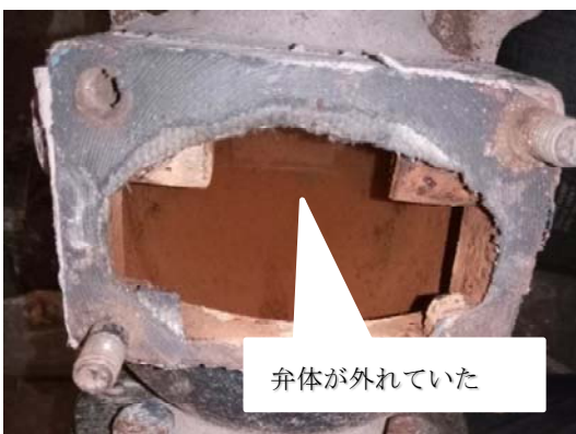
写真 3.18 揚水した水が井戸に戻り、エネルギーロスが生じる原因となる閉止不可の著しく腐食した逆止弁
