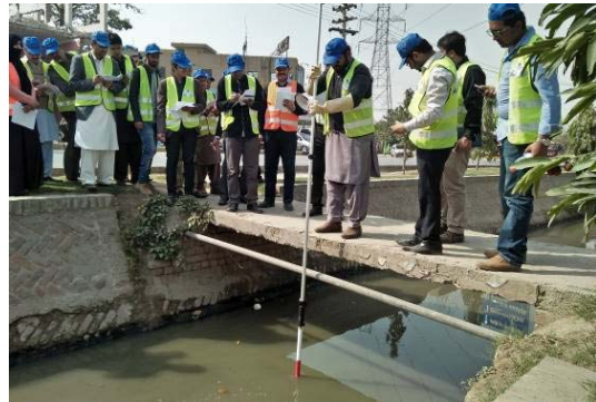
写真10: 汚泥量測定の実験演習
