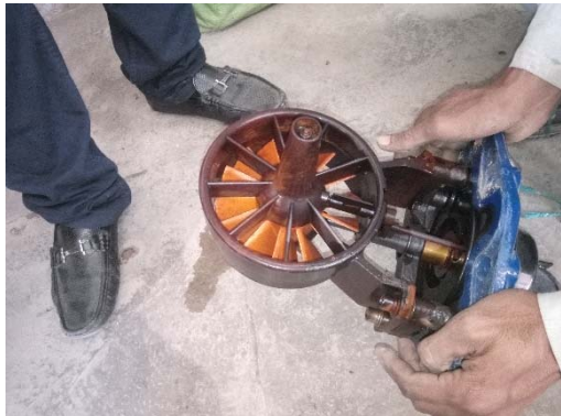
写真 4.3 流量計の羽根車のチェック
