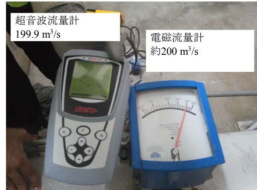
写真 4.4 超音波流量計と電磁流量計による流量測定結果の比較
