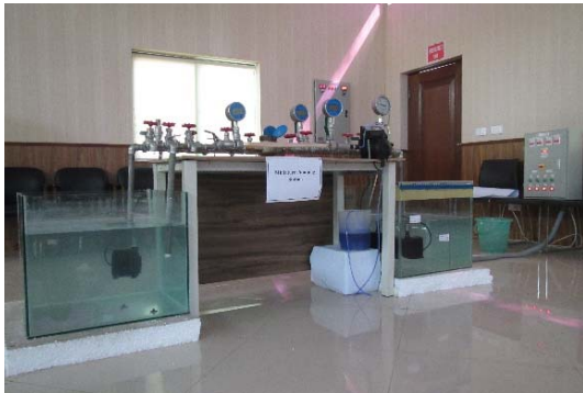
写真19: ポンプ場のミニチアモデル
