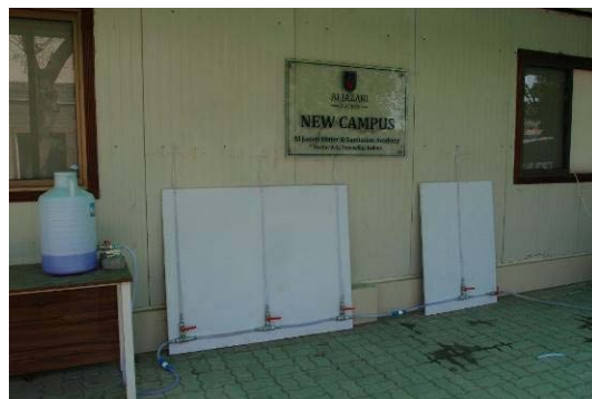
写真4: 水理モデルによる水頭損失の確認
