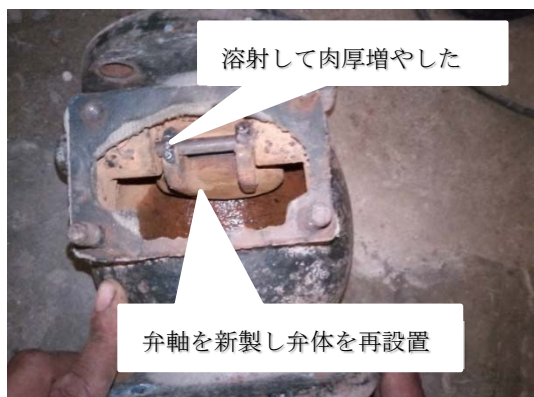
写真 3.19 弁軸の追加、肉厚の回復、止水用パッキンの設置により、一定レベルまで回復した逆止弁
