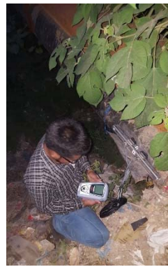
写真6.9 超音波流量計の設置および流量測定（測定日：2017年6月8日）
