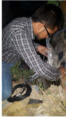
写真6.9 超音波流量計の設置および流量測定（測定日：2017年6月8日）
