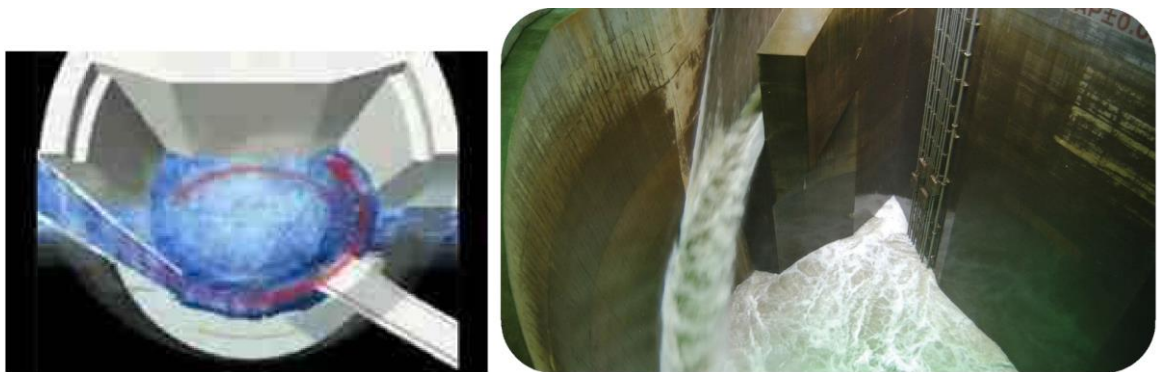
a) 渦流式ドロップシャフトの説明図
