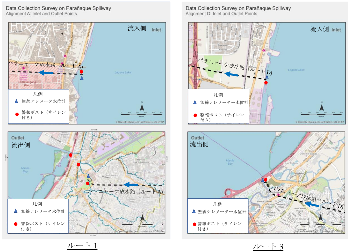
図 7.4.1 パラニャーケ放水路（ルート 1 と 3）への テレメーター水位計及び警報ポスト設置（案）
