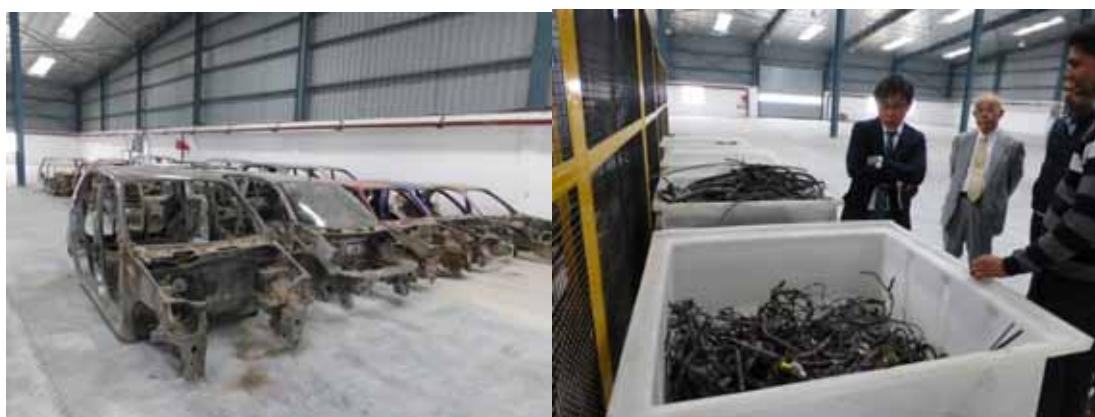
写真 3－3 Mahindra MSTC Recycling 社グレータノイダ工場 (解体した廃車からは部品を分別回収して、廃車 17 台からワイヤーハーネス約 100kg (小型車一台あたり約 6 kg) を回収している。)
