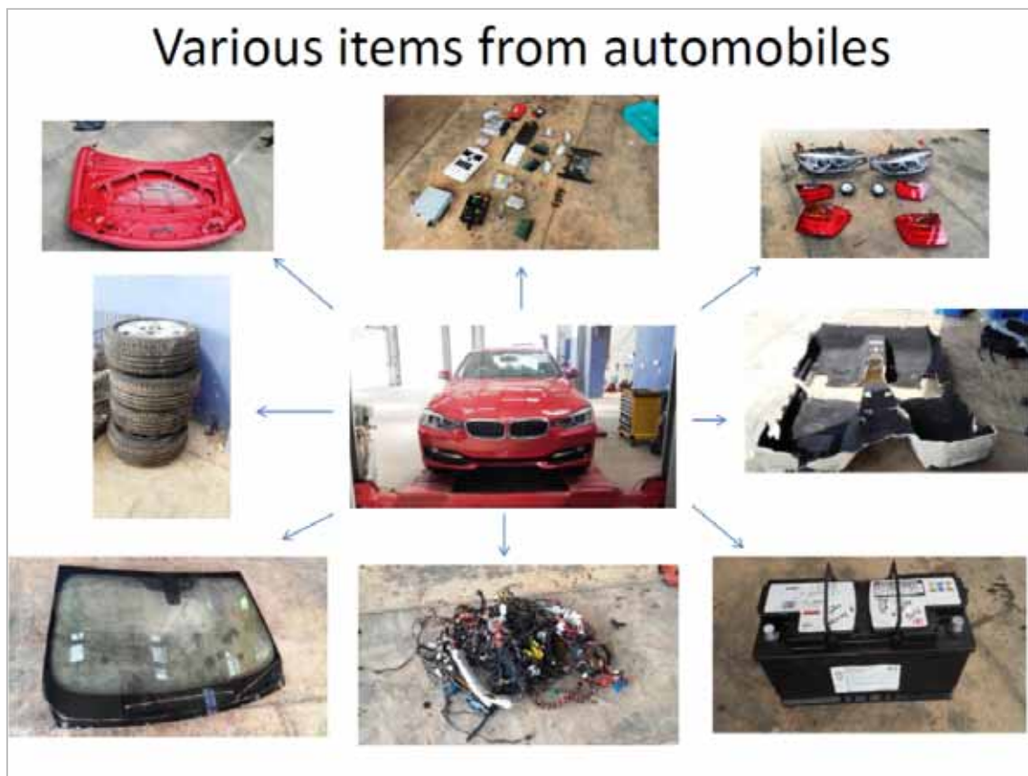
図 4 - 2 RDU の廃自動車解体ラインの解体事例
