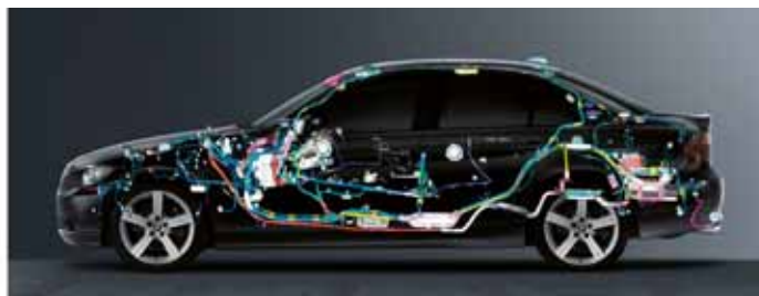
写真 3－1 BMW 車のワイヤーハーネス配線透視図
