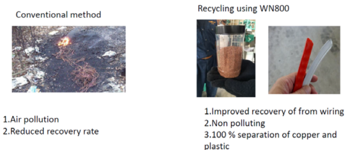
図 1－1 インフォーマル業者の銅処理と本技術の比較 出典：2016 年 11 月 4 日 GARC でのワークショップ講演より
