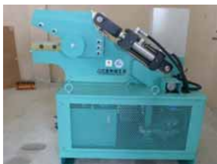
写真4 HAS-250 型アリゲータシャーリング (剪断加工機) (2016年9月)
