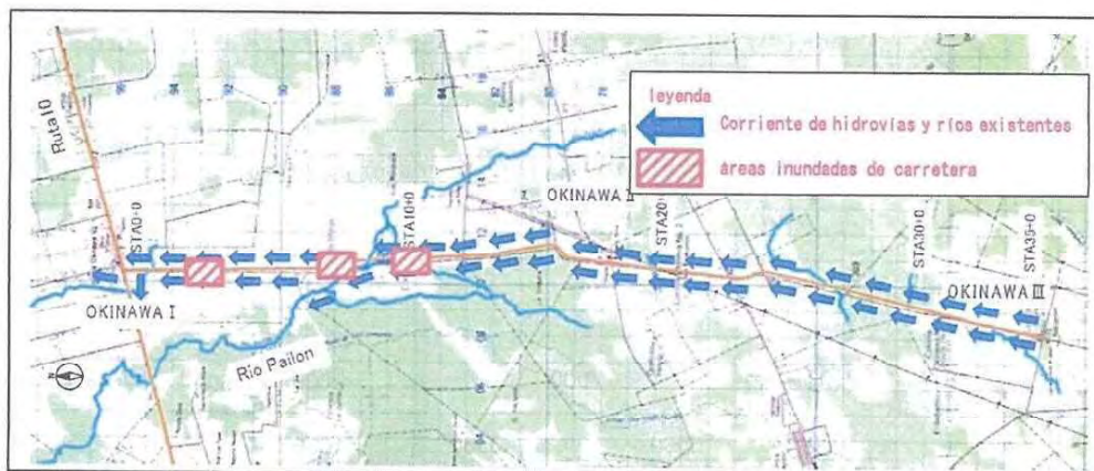
Figura 5-1 Ríos • hidroviás en los alrededores de la carretera Okinawa y tramos inundados de dicha carretera
