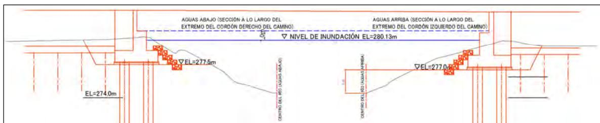
**Figura 2-2-22 Profundidad de empotrado de los estribos**
