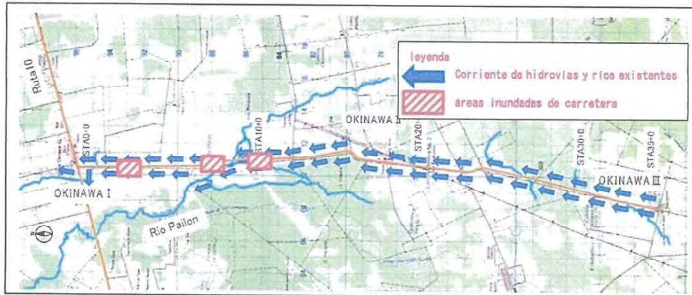
Figura 5-1 Ríos • hidroviías en los alrededores de la carretera Okinawa y tramos inundados de dicha carretera
