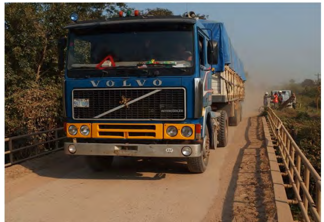
橋梁を走行する過積載車両
