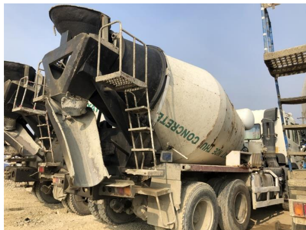
写真 26 コンクリートミキサー車
