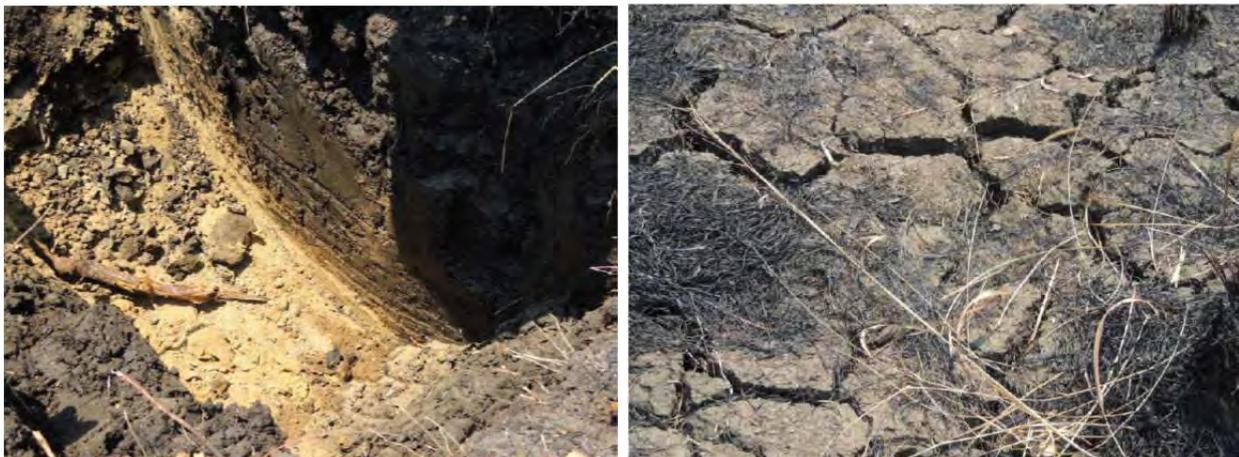
図 8.2.14 地表を覆う有機質土と表面に発達する特有のクラック（クアンババイパス道路）
