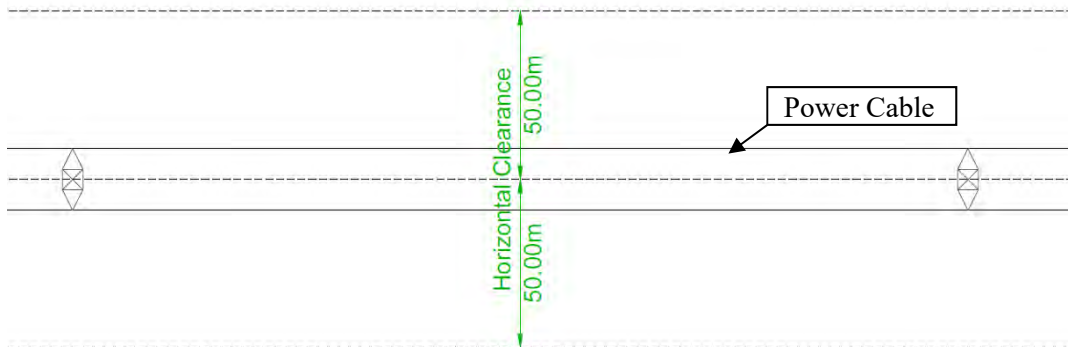
図 6.2.3 送電線との平面クリアランス
