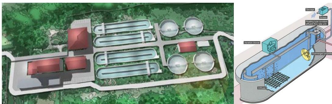
図 4.3-2 Kandy 下水処理場 (14,000m 3 /d、窒素除去 OD 法)
