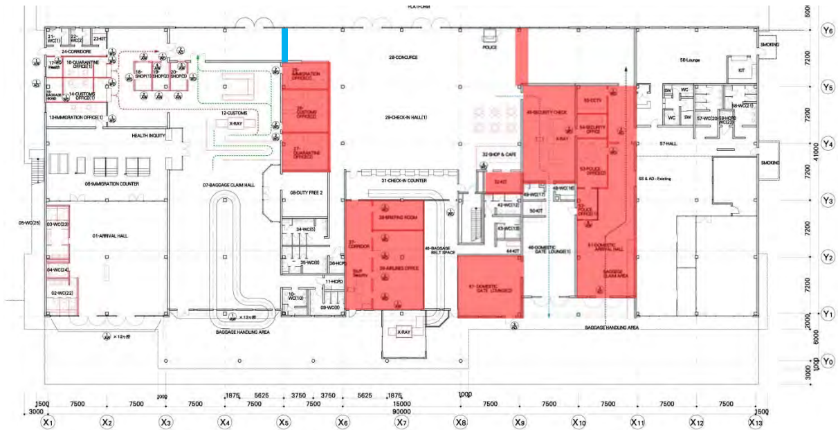
図 88 ETB 改修施工手順 (Phase2)
