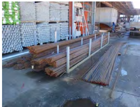
写真 69 現地で入手可能な鉄筋
