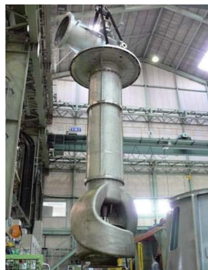
Конденсатный насос Геотермическая электростанция Поларис Никарагуа
