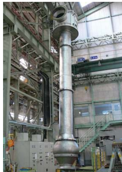
Заборный насос морской воды Опреснение Завия (МЕД) Ливия
