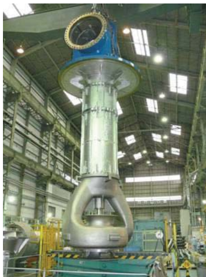
Рециркуляционный насос минерализованной воды Опреснение Шувейхат S2 desalination (многостадийное мгновенное испарение) ОАЭ
