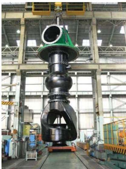
Рециркуляционный насос минерализованной Воды Опреснение южной Шуайбы (многостадийное мгновенное испарение) Кувейт
