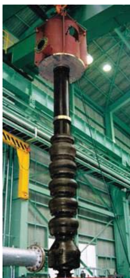
Конденсатный насос Электростанция Лама Гонконг, 1 × 350МВт
