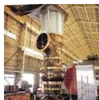
Циркуляционный водяной насос для промышленного комплекса в Саудовской Аравии
