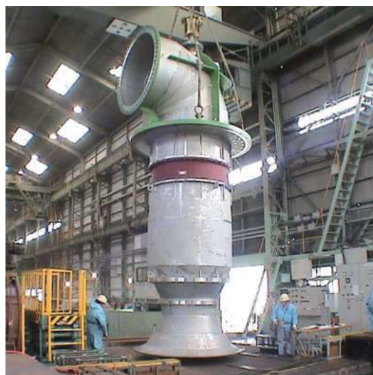
Циркуляционный водяной насос Угольная электростанция Пасифико Мексика, 1 × 700МВт
