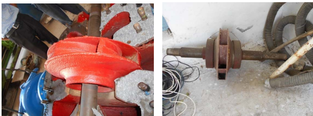
図 2-11 インペラー部分の磨耗の状況
