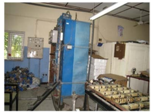
メータ検定装置。2 基あるうち 1 基は故障（於：Meter Workshop and Testing Lab）
