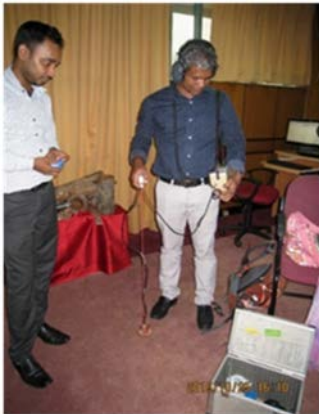
電子式漏水探知機を装着した職員。漏水音検知部は軽く、使いやすい(於：西部州中部RSC)
