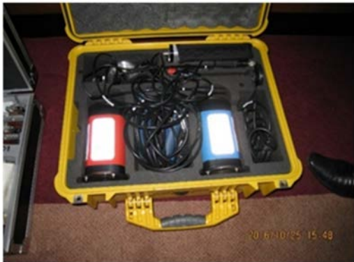
相関式漏水探知機。2台あるうち1台は使用不能(於：西部州中部RSC)
