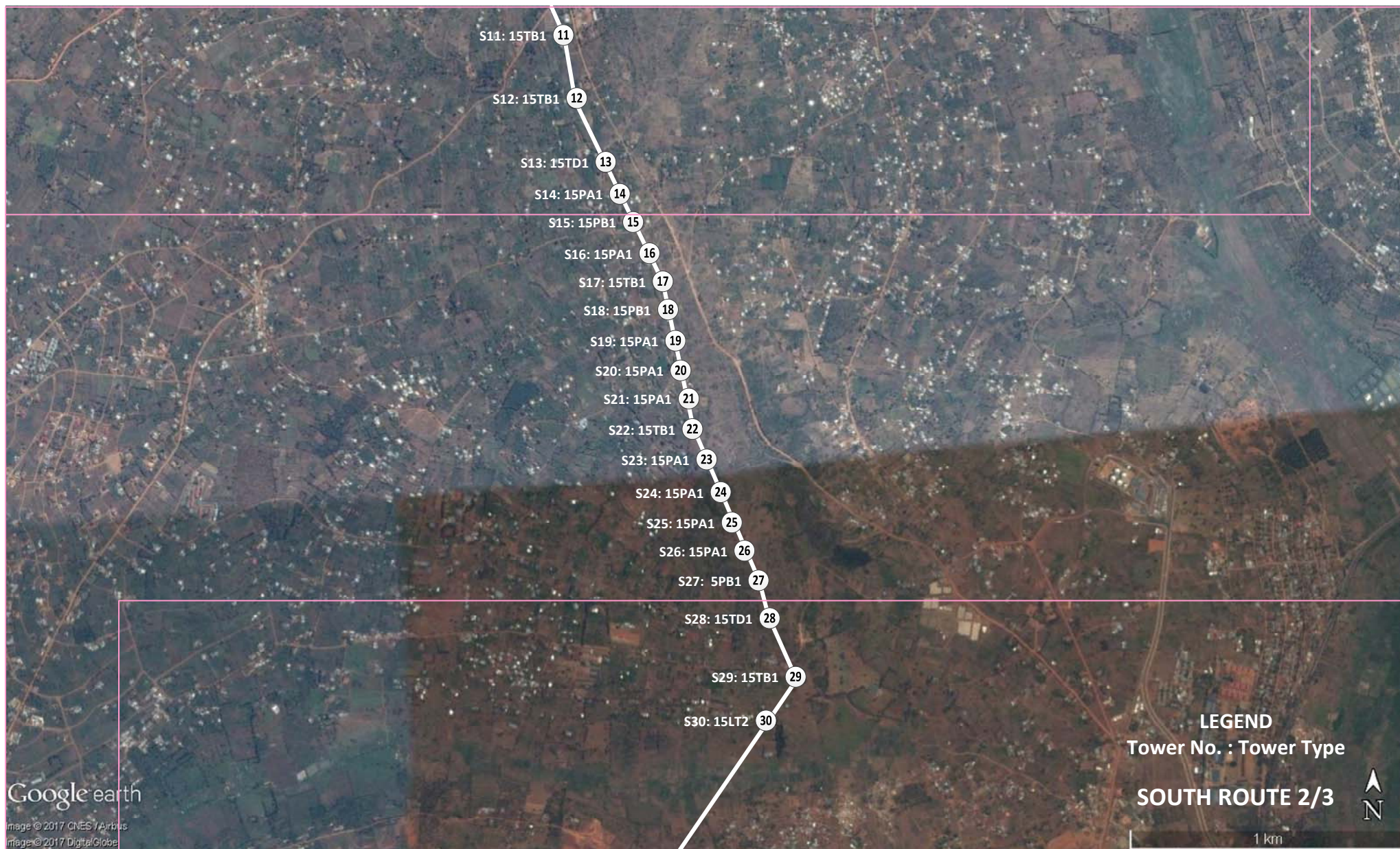
Dwg. No. DR-03: 15kV 配電線ルート(新ガソギ変電所 - マサカ病院接続点間: 約8.5km) 2/3
