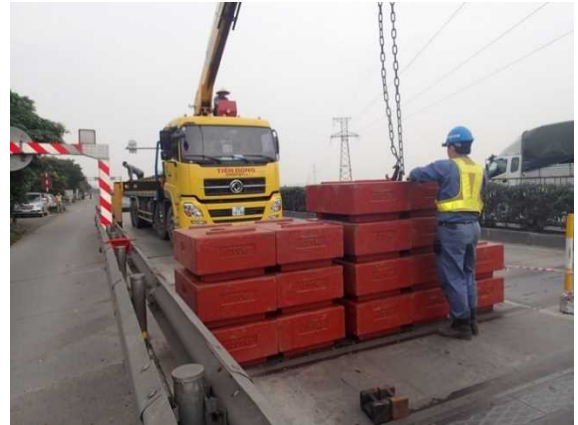
卷頭写真 10：現地検定試験 静止計量試験
