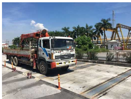
検定試験： 走行計量 3軸
