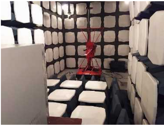
卷頭写真 7：型式試験 電波試験
