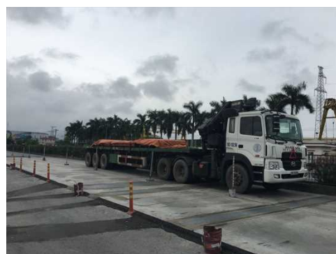
検定試験： 走行計量 6軸
