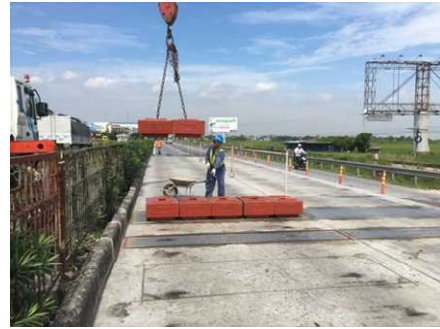
検定試験： 静止計量試験
