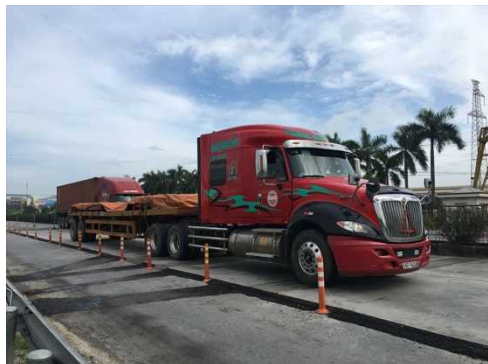
検定試験： 走行計量 5軸
