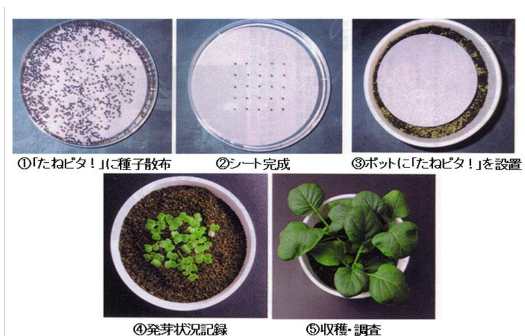
写真3-4 タネピタを用いた発芽およびポット栽培試験要領
