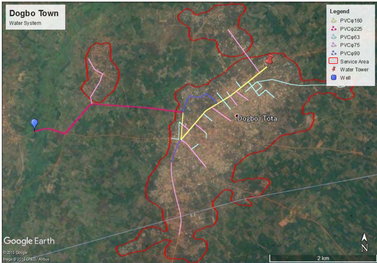
図 5.1.12 ドボ市 既存給水配管図
