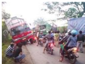
オーバーレイ工法により脱輪した車
