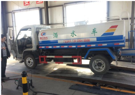
車検場での排ガス計測の様子（ディーゼル車）
