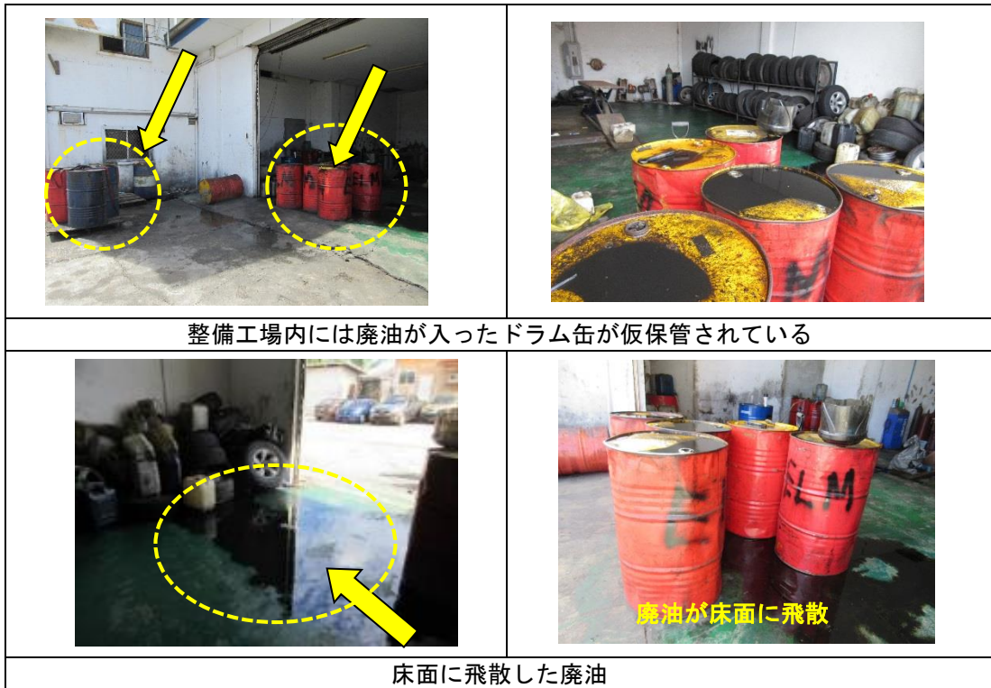
写真 1-3 自動車整備工場の廃油排出・保管状況（ELM Motors、デラップ地区）
