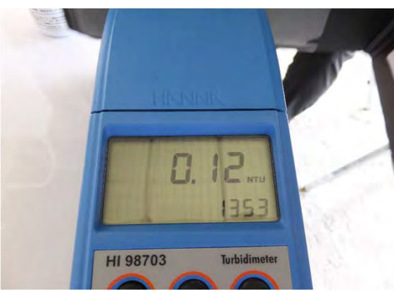
浄水場建設現場 高架水槽出口濁度 撮影日 2016年10月3日
