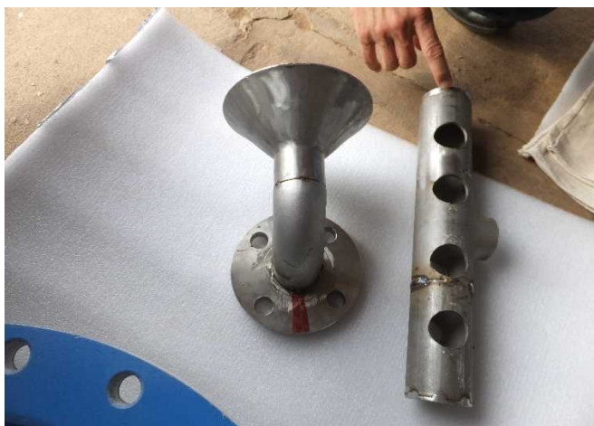
散水管/製作途中(ボルト穴振り分け具合悪い)
