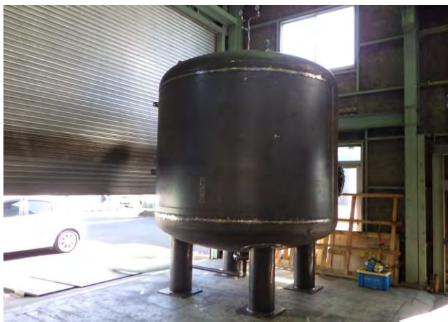
耐压検査全景
