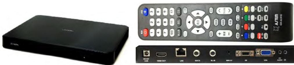
図 2-2 : 「アイ・ドラゴン」の本体（左と右下）及び付属リモコン（右上）
