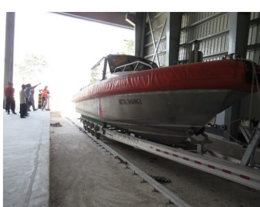
CG Base Chittagong Repairing Centre の上架設備。米国供与のウォータージェット型高速艇が整備中。
