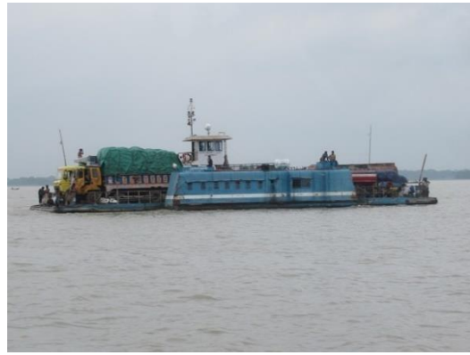
トラック、バス等大型の車両も搭載したフェリー。バランスを崩すと転覆する危険性がある。
