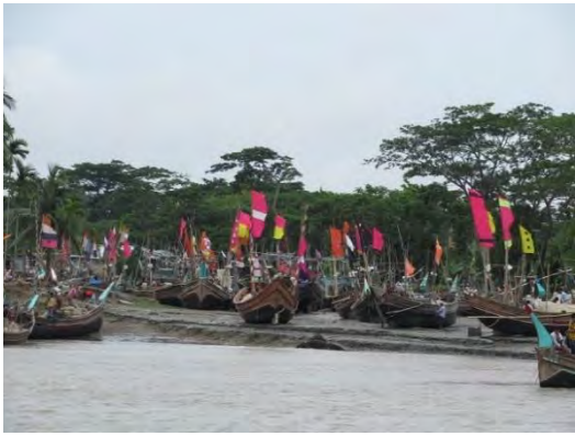
中型木造漁船群。干満差が大きいので、干潮時には陸揚げ状態となる。
