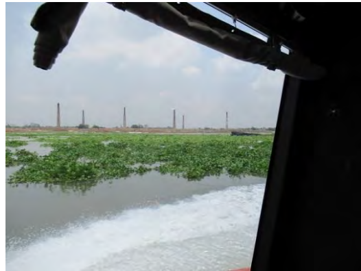
航路を漂流する多量の水草。ウォータージェット式推進機関では、吸い込み、度々機関を停止・逆転させ、除去する必要がある。
