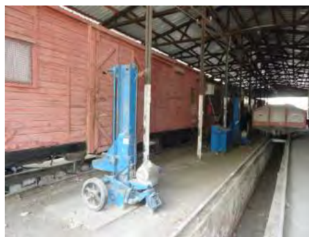
図 5.11.5 貨車のための車両基地 (ミョウハウ車両基地の検査ピットとリフティングジャッキ) の設備例
