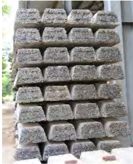
図 5.3.37 完成した PC まくらぎの端面
