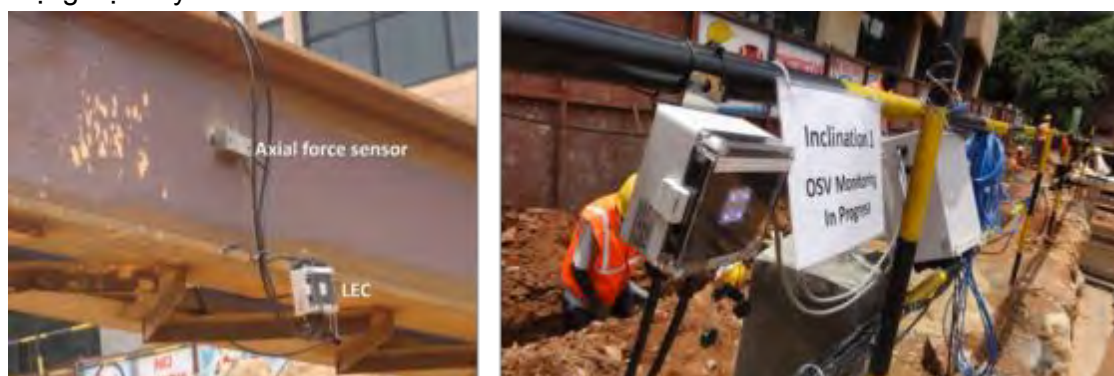
Hình 6.2.2.17 Đo lực dọc trục của thanh chống và độ nghiêng của tường chắn đất bằng thiết bị OSV ở Bangalore Metro
