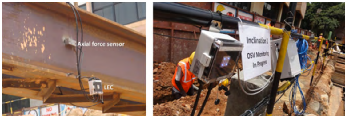
図 6.2.17 切梁軸力、掘削山留めの傾斜を OSV で計測(バンガロール地下鉄)
