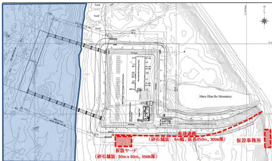
図 3-2-53 仮設事務所及び仮設ヤード（最初期の乾季のみ）エリア
