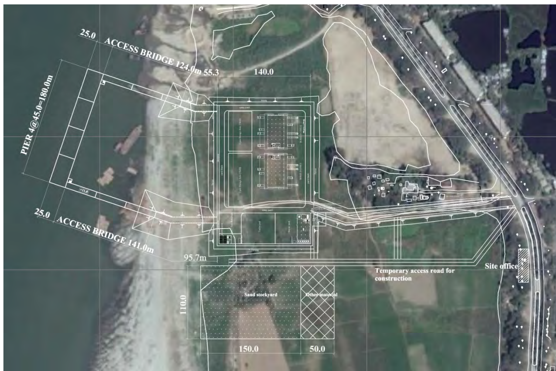
図 2-2-33 既存道と新設道路、両方を利用する案 (a) のレイアウト
