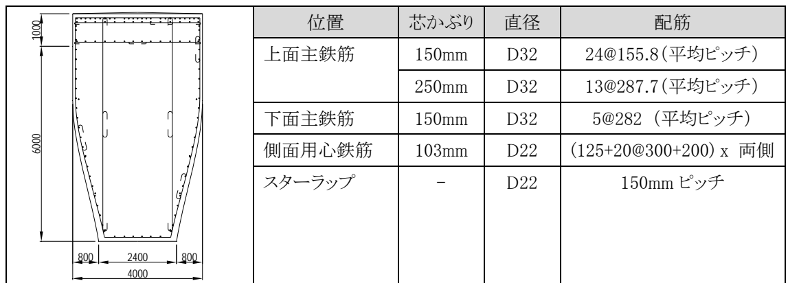
図 4.3.73 梁の配筋図
