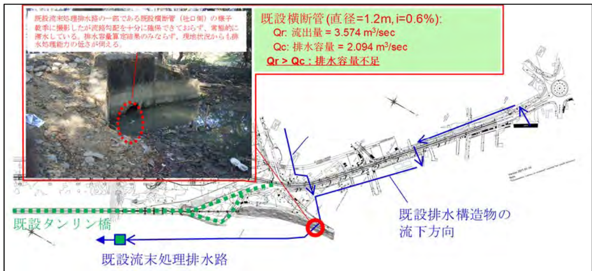
図 3.8.6 右岸側 既設の流末処理排水路の排水容量不足
