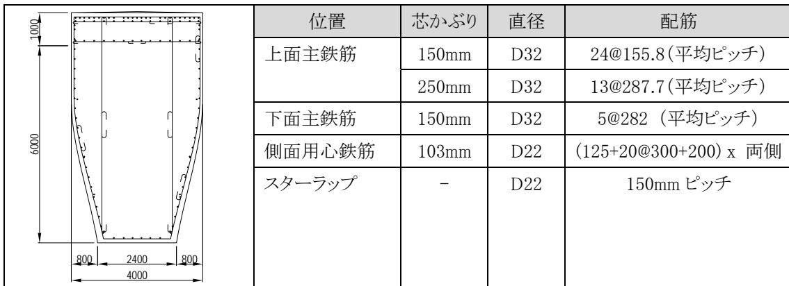
図 4.3.19 梁の配筋図
