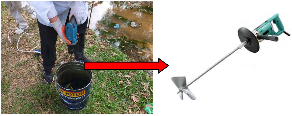
Photo 5.2.2.27 លាយអោយស្រប (Impregnating resin)
