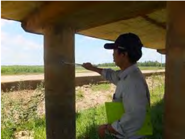
រូបថត ៣.៧.១ ការធ្វើតេស្តសាកល្បងដោយប្រើញញូរ Hammering test
