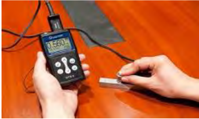
រូបថត 5.4.2.2 ដំណើរការឧបករណ៍វាស់កម្រាស់ដោយសូរអ៊ុលត្រា Gauge
