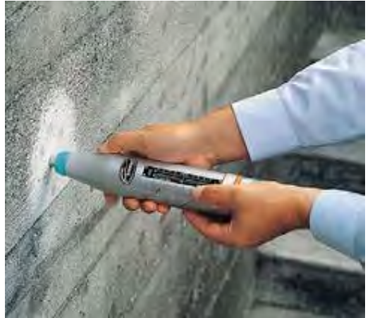
រូបថត 5.3.1.1 ទីតាំងតេស្ត ដោយប្រើញញួរតេស្តបេតុងធម្មតា
