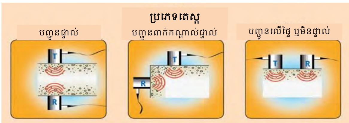
រូបភាព 5.3.3.2 ការរៀបចំឧបករណ៍ T – Transducer, R-Receiver
