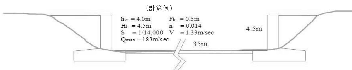
図 6.5 イブラヒミア基幹水路改修断面案
