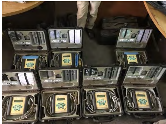
LWB 保有機材（超音波流量計） LWB 本部（2017/8/1）
