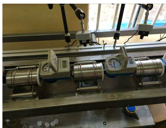
LWB 既存施設 (水道メータ用テストベンチ) LWB 本部試験室 (2017/7/19)
