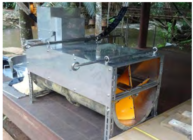
図 3 螺旋式マイクロ水力発電機
