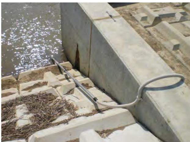
Sistema instalado combinando con el instrumento de medición (medidor del nivel de agua)
