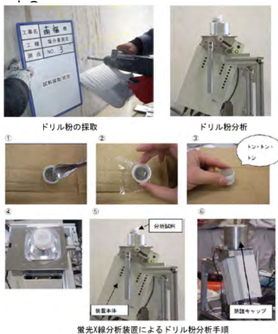
蛍光X線分析装置によるドリル粉分析手順
