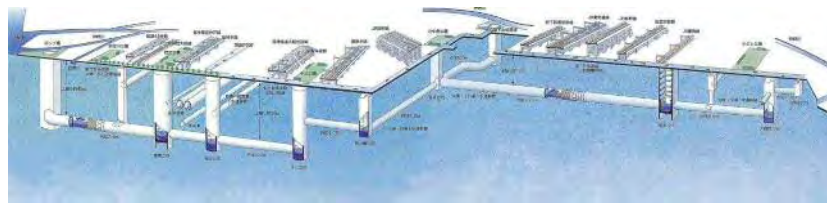
幹線管渠（遮集幹線）の配置（概念）
