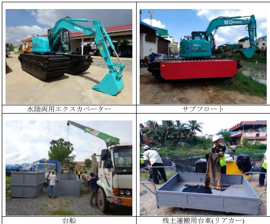
写真 3-1 製造した水陸両用エクスカベーターおよび付帯設備
