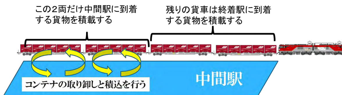
図 4-4 例：1つの列車に複数の駅に到着するコンテナを積載するためのルール
