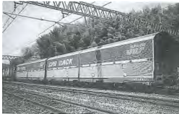
写真 2-9 コキ 71 形式 39.2t 積コンテナ車（カーラック・システム）
