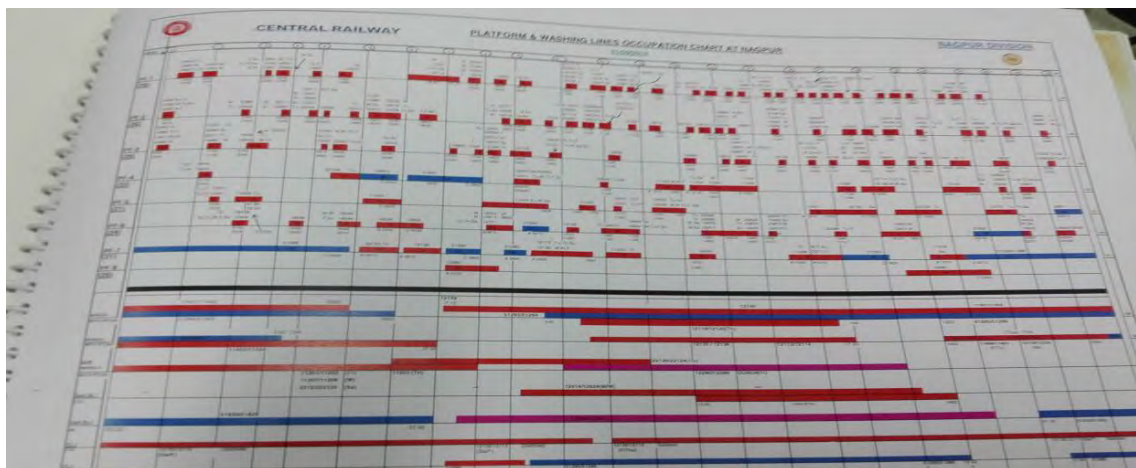
図 2-15 図表化された構内ダイヤの例
