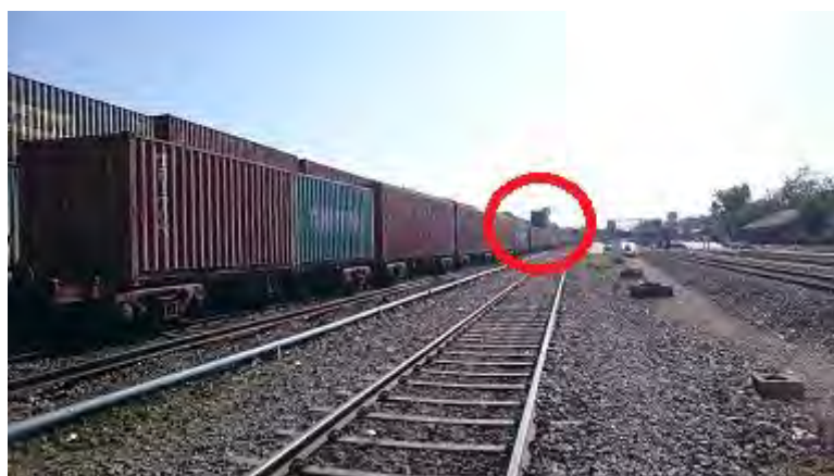
写真 2-3 部分的に 2 段積みになっているダブル・スタック・コンテナ列車
