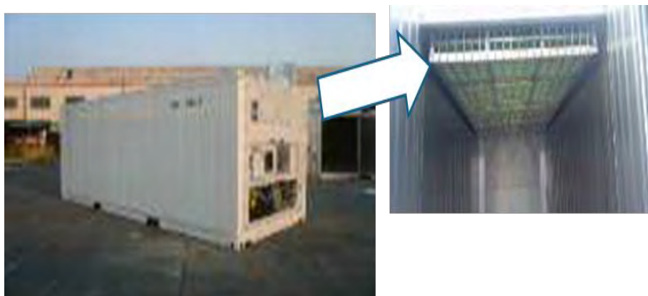
写真 4-2 日本の鉄道輸送におけるアイスバッテリー・コンテナ (ITE 社)
