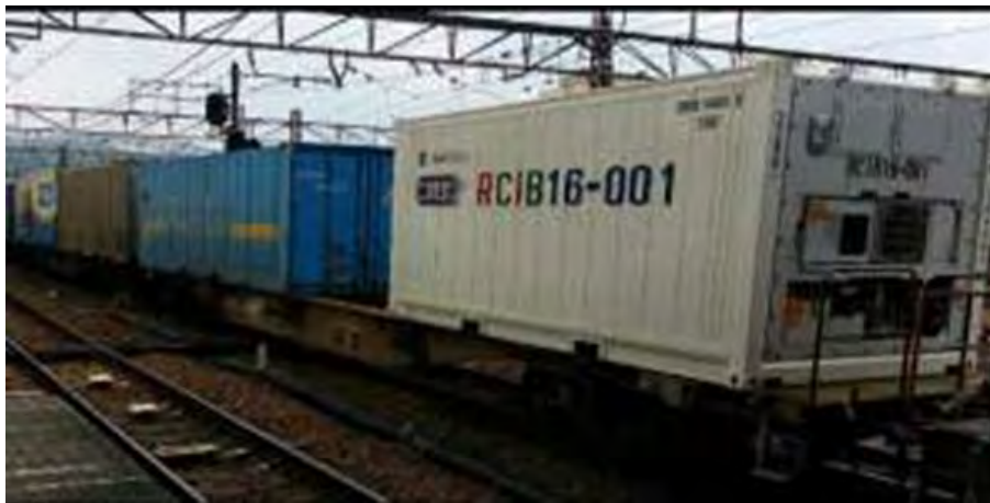
写真 4-3 日本の鉄道輸送における定温コンテナ（JR 貨物）
