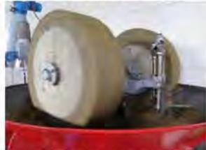
伝統プレス式: 破砕されたオリーブを電動石うすにて攪拌し、ペースト状にする。
