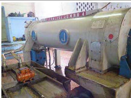
3相型搾油工場:遠心分離機。ペースト状のオリーブに温水を加え、オイル分を分離させる。
