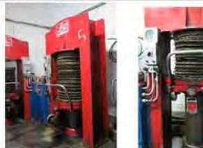
伝統プレス式: プレス機。(左)圧搾直後、(右)圧搾完了。
