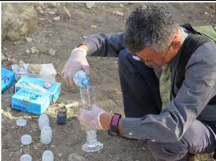
フェズ近郊マルジン蒸発貯留池における簡易水質検査の様子
