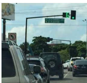
左上：カウントダウン信号、右上：右折矢印信号 出典：サンタクルス市信号標識課
