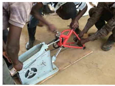
写真 22 ウガンダ人による稼働テスト。現在の機構では稼働時間が短いのが課題。
