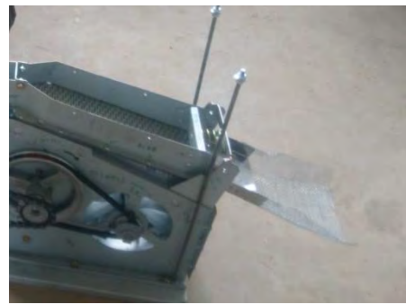
写真 23 手回し式石抜き機に網を付ける。この改造だけで碎米が除去可能となる。
