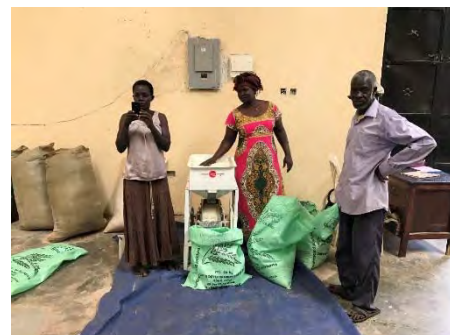
写真16 アモラタ県女性団体HDIの作業場での石抜き機利用。コメが処理されている。
