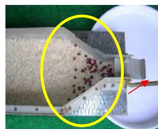
⑥石が無くなった段階でシャッターを閉じる
