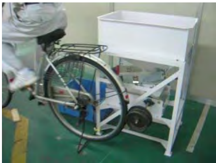
写真 20 自転車駆動式石抜き機。モーターを使用せずコストダウンが期待できる。
