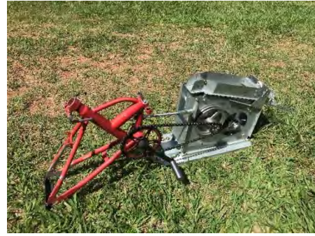
写真 21 開発した手回し式石抜き機。電気が整備されていない所で活躍できる。
