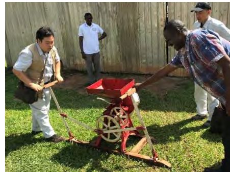
写真 24 手漕ぎ糲すり機(他社製)。小さな力で長時間高回転を得られる機構。
