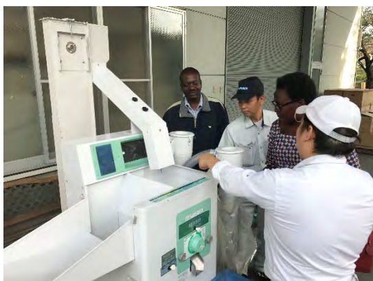
写真2 石抜き付き精米機ユニット メカニズムについて感心。現地利用を検討
