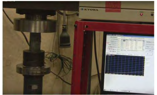
国内での圧縮試験の実施
