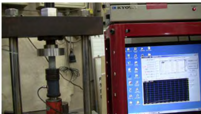
写真3-2 圧縮強度試験、耐酸性試験供試体
