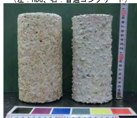
写真3-2 圧縮強度試験、耐酸性試験供試体
