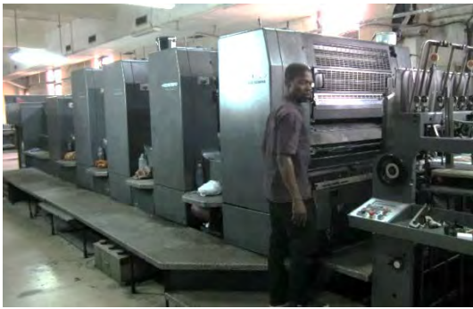
写真-9：雑誌等を印刷する印刷機。紙面が新聞よりサイズが小さく印刷機のサイズも小型。
