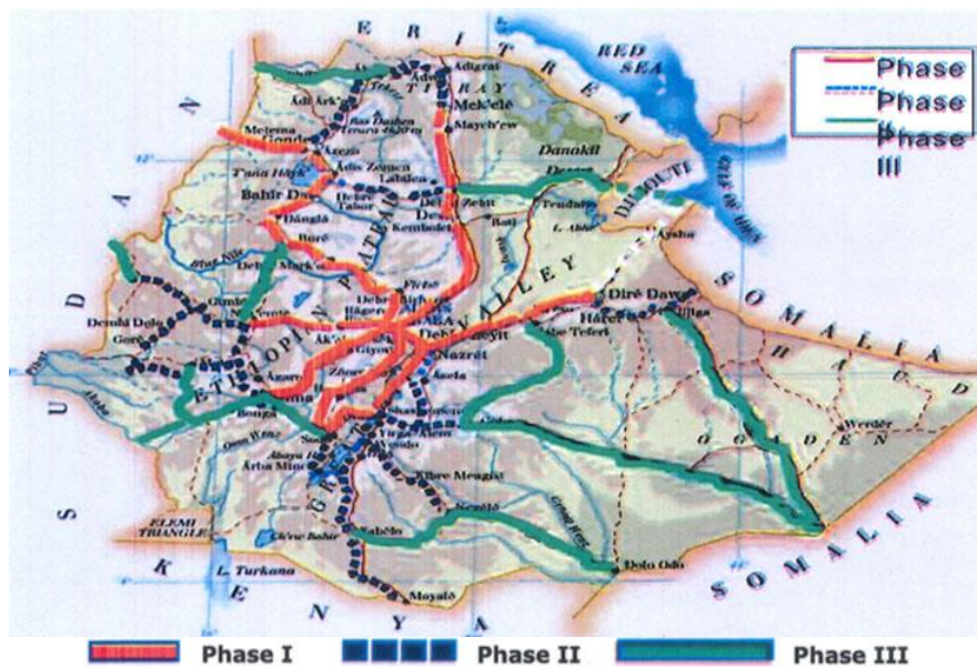
Source : Ministère des Communications et des Technologies de l'information (MCIT), Éthiopie Figure 5.5.2 Plan d'aménagement d'un réseau dorsal à fibre optique (Éthiopie, état en 2012)
